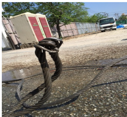
(損傷したワイヤーロープ)
